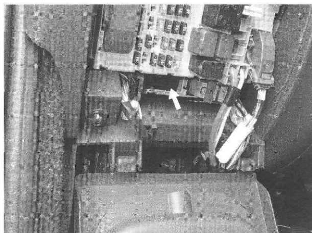
Rys. 12.46. Widok węzła skrzynki bezpieczników i komputera pokładowego po otwarciu pokrywki (strzałka wskazuje łączące diagnostyczne)
