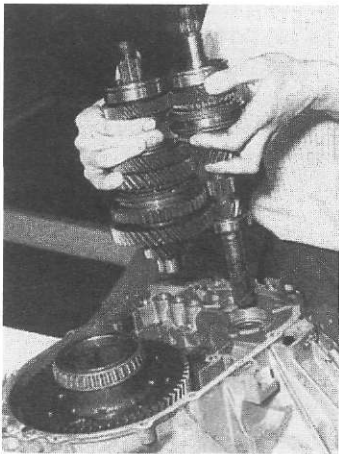
Rys. 4.9. Wymontowanie zespołu kół zębatych i wałków
