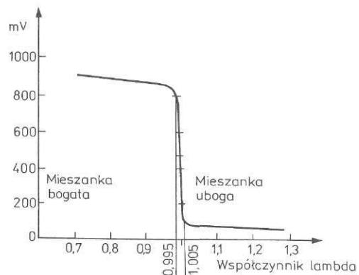
Rys. 2.34. Charakterystyka sondy lambda
