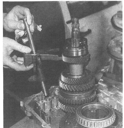
Rys. 4.8. Wymontowanie zespołu widełek biegów 3-4 oraz wodzika widełek 5. i wstecznego biegu
