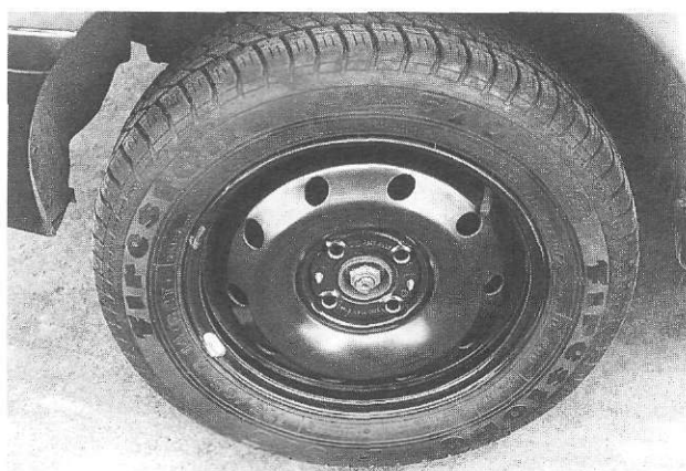
Rys. 1.61. Założenie koła zapasowego przed przykręceniem śrub mocujących
