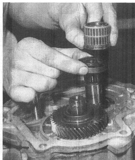
Rys. 4.5. Wymontowanie z wałka sprzęgłowego łożyska igiełkowego i pierścienia oporowego koła zębatego 5. biegu
