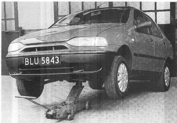
Rys. 1.93. Podnoszenie przodu samochodu podnośnikiem samochodowym
