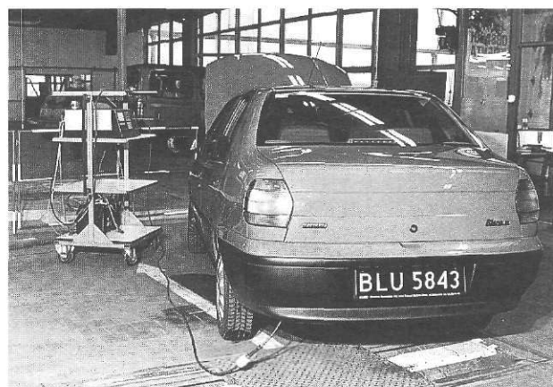
Rys. 2.84. Analizator spalin podłączony do końcówki rury wylotowej
