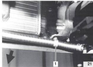
Abgasanlage und Brennluftansaugleitung (Fahrtrichtung rechts)
