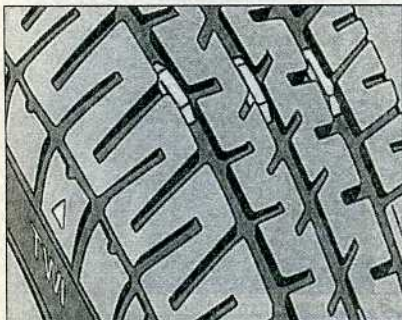
17.0 Измерение высоты рисунка протектора и метки износа
