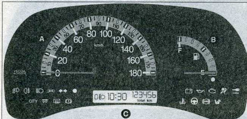
Тип 1 - щиток приборов со спидометром А, указателем В запаса топлива и дисплеем С
