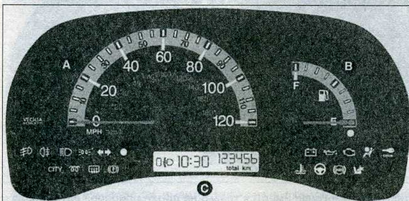
Тип 2 - щиток приборов с тахометром А, указателем В запаса топлива и дисплеем С
