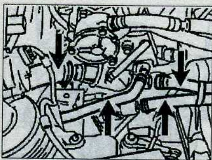
4.117 Отсоедините шланги от радиатора отопителя (см. стрелки)
