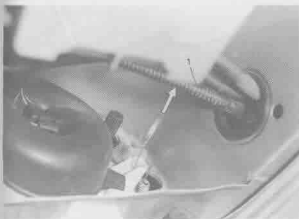
Rys. 1.73. Sprężyna mocująca klosz lampy kierunkowskazów przednich (strzałka wskazuje kierunek pociągnięcia). 1 – sprężyna
