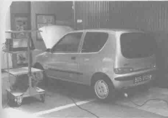
Rys. 2.103. Widok analizatora spalin podłączonego do końcówki rury wylotowej
