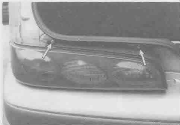
Rys. 1.76. Lampy tylne zespolone (strzałki wskazują wkręty mocujące)
