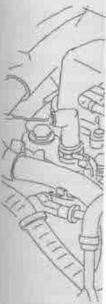
Rys. 2.89. Demontaż złącza konektorowego czujnika temperatury silnika systemu wtryskowo-zapłonowego 1 - złącze konektorowe czujnika temperatury silnika, 3 - wiązka przewodów
