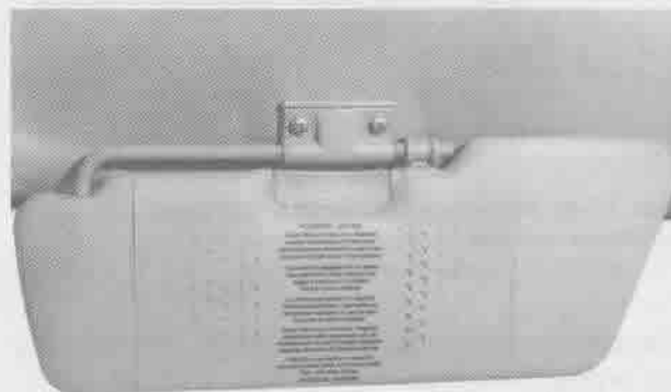
Rys. 11.55. Zawias osłony przeciwsłonecznej
