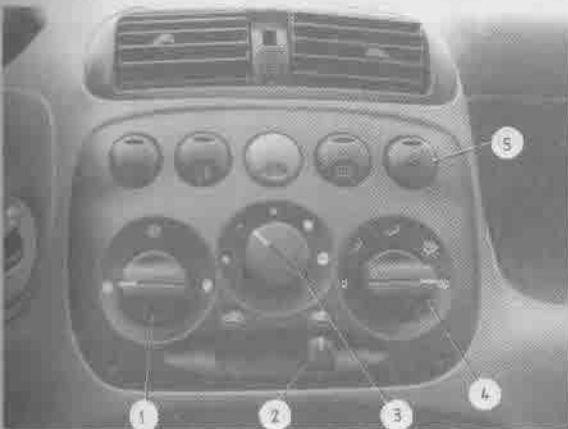
Rys. 1.37. Elementy sterowania ogrzewaniem, przewietrzaniem i klimatyzacją
