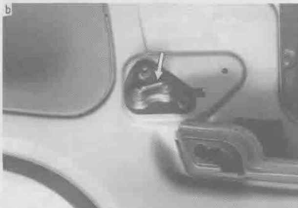
Rys. 1.50. Dźwignia zaczepów oparcia siedzenia tylnego Strzałkami wskazano przycisk dźwigni (a) i zaczep przycisku (b)
