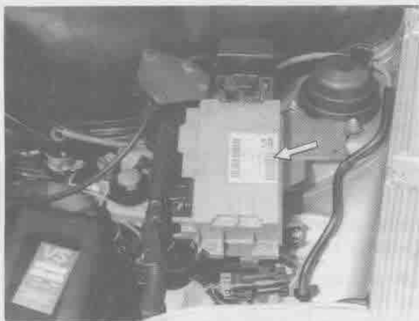
Rys. 1.13. Usytuowanie elektronicznego urządzenia sterującego systemem wtryskowo-zapłonowego w samochodzie z silnikiem 899 (strzałka wskazuje urządzenie sterujące)
