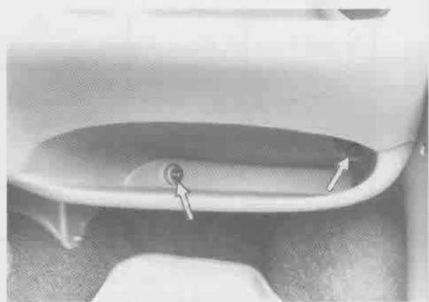
Rys. 77.47. Śruby mocujące tablicę rozdzielczą, znajdujące się w schowku po prawej stronie tablicy rozdzielczej
