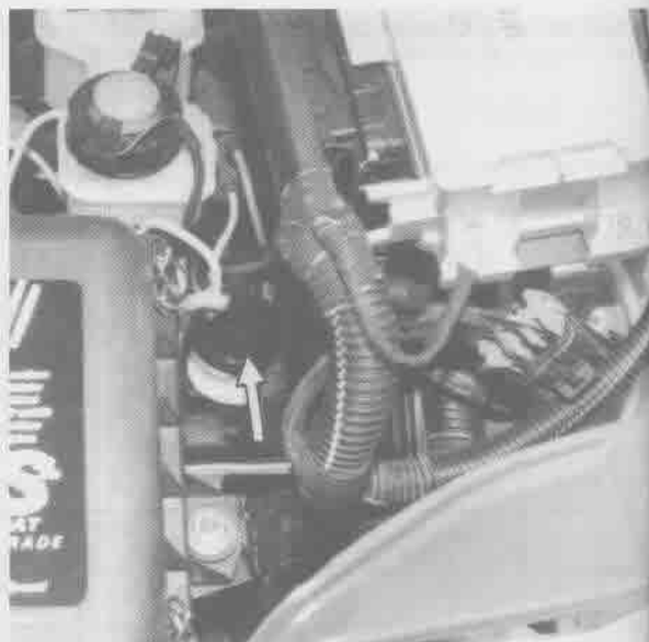
Rys. 1.57. Usytuowanie zbiorniczka płynu hydraulicznego układu sterowania sprzęgłem (strzałka wskazuje zbiorniczek)
