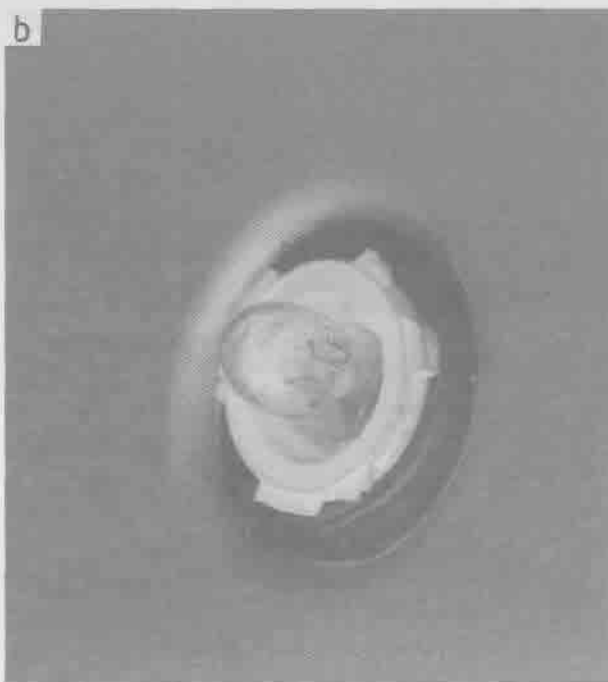
Rys. 1.75. Lampka kierunkowskazów bocznych a – otwieranie, b – widok po odkręceniu klosza, O – kierunek otwierania, Z – kierunek zamykania
