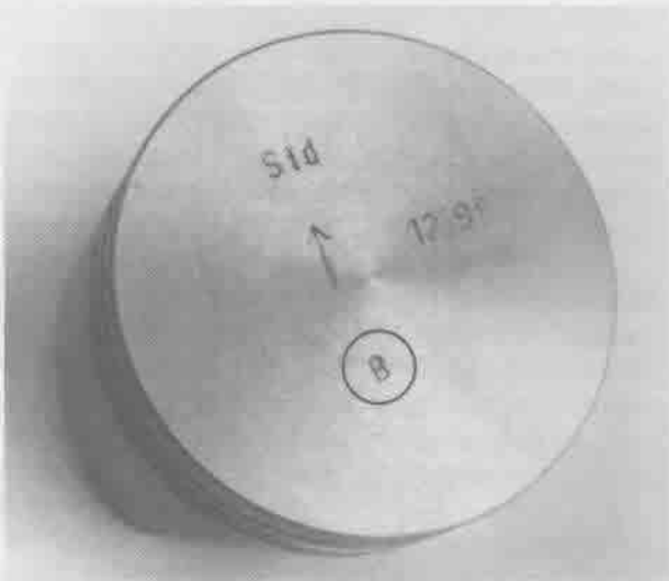
Rys. 2.177. Oznaczenie grup selekcyjnych tłoków w silniku 899
