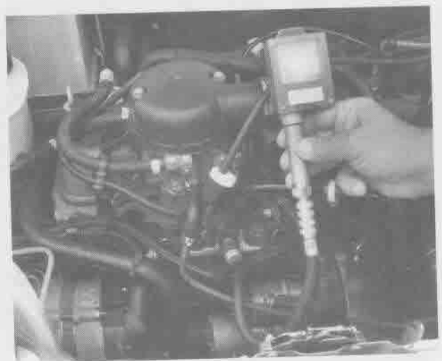
Rys. 2.101. Pomiar ciśnienia sprężania
