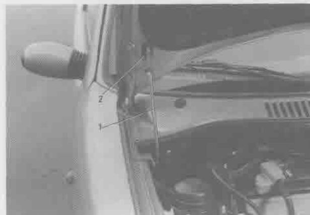
Rys. 1.42. Podpórka pokrywy przedziału silnika 1 - podpórka, 2 - gniazdo w pokrywie
