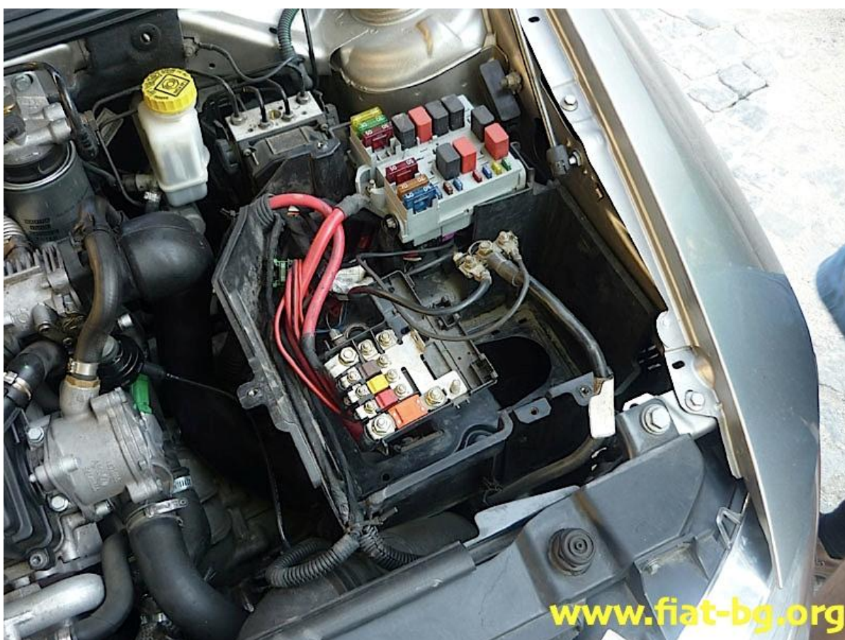
Стъпка 3: Отстраняване на голямото сиво табло с повечето главни бушони (държи се на един винт и жлеб)
