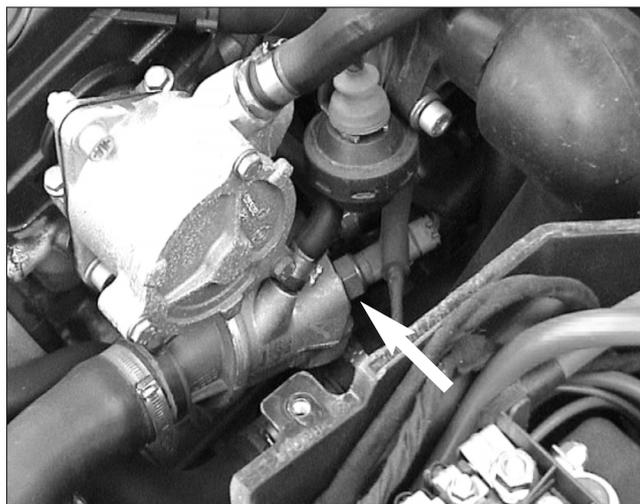
Sensore temperatura motore
