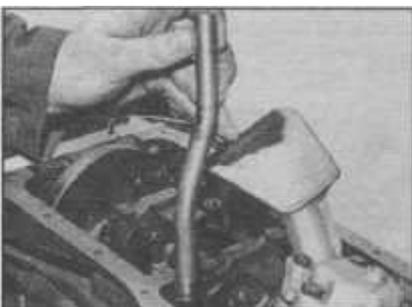
34.4В ...и снимите трубку сапуна картера
