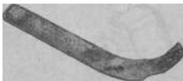
4.16 Специальное приспособление для удержания толкателя клапана в нажатом положении
