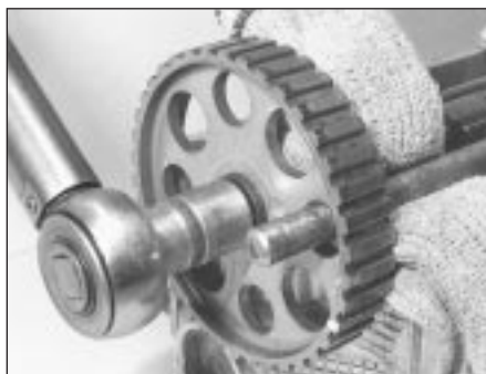
5B.22A Unscrewing the camshaft sprocket bolt
