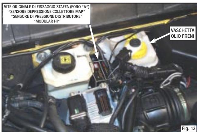
Rimuovere i tre raccordi originali presenti nella parte inferiore dei due sensori e sostituirli con le tre curve a 90° in dotazione avvitandole sui due sensori con la parte di filetto più corta ed utilizzando sulle filettature il sigillante consigliato (Loctite n° 83-21) vedi figura 12 pagina precedente.
